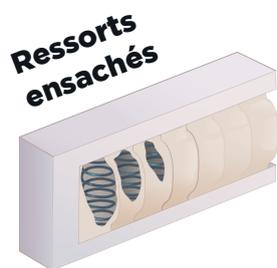
C'est la dernière technologie en matière de ressort. Chacun d'entre eux est «emballé» dans un sachet individuel. De multiples avantages en découlent : l'aération est idéale, à chacun de vos mouvements l'air circule dans le matelas évitant ainsi l'augmentation de la température corporelle. C'est le type de matelas qui s'adapte le mieux à la morphologie de chaque personne et présente la plus grande indépendance de couchage évitant ainsi de réveiller sa/son partenaire au cours de la nuit.
